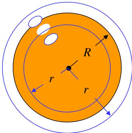
Para  $r > R$ : para esta superfície gaussiana, todo o volume de cargas se comporta como uma carga puntiforme → então é carga puntiforme.
