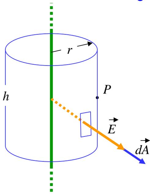
a) Problema: calcular o campo elétrico no ponto  $P$ , a uma distância  $r$  do fio/barra fina, isolante.
