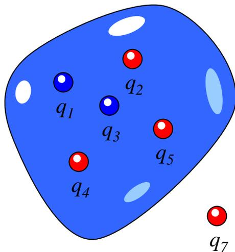
2) As cargas elétricas externas à superfície gaussiana (superfície azul envolvendo  $q_1, q_2, \dots$ ) não contribuem para a Lei de Gauss  $\rightarrow$  contribuem com um fluxo *zero*.
