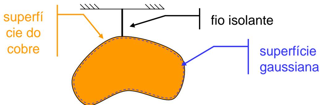
Características: Seção transversal de um pedaço de cobre isolado por um fio isolante, e tendo uma carga adicional  $q$ .
