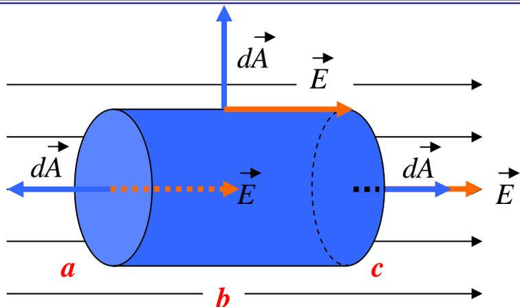
Características: cilindro de raio  $R$  e área de base  $A$ , em um campo elétrico uniforme. Campo elétrico paralelo ao eixo do cilindro.
