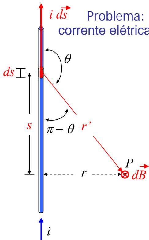
Problema: fio retilíneo longo (algumas vezes tratado com fio infinito) percorrido por uma corrente elétrica  $i$ . Encontrar o campo magnético em um ponto  $P$ , a uma distância  $r$  do fio.
