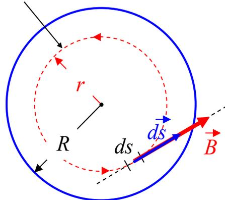
Características: seção transversal de um fio retilíneo longo, de raio  $R$ , transportando uma corrente  $i_0$ , uniformemente distribuída sobre a seção transversal, e emergindo da figura.
