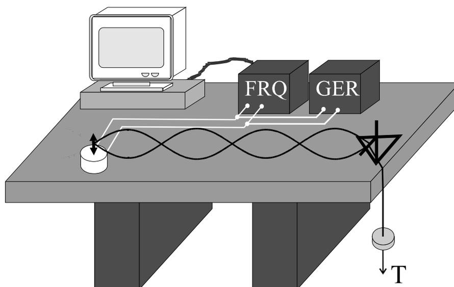
FIG. 2 - Esquema do aparato experimental – corda vibrante.
