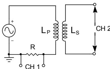
Figura 6-1 - Circuito para medição da indutância mútua
