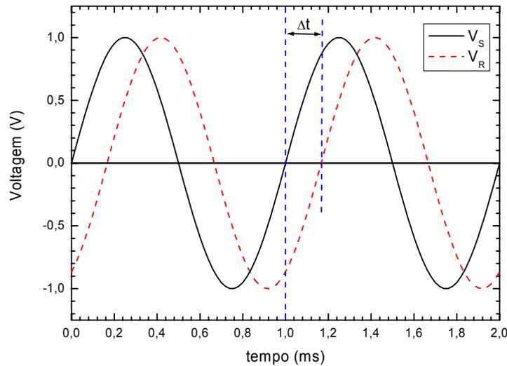
**Fig. 6-1:** As formas da tensão no circuito RL da nossa montagem experimental. A linha contínua representa a tensão de referência da fonte ( $V_A$ ), e a linha tracejada a tensão no resistor ( $V_B$ ). Como já foi visto, em um resistor a corrente e a tensão estão em fase. A diferença de fase que está ocorrendo deve-se à presença do indutor.
